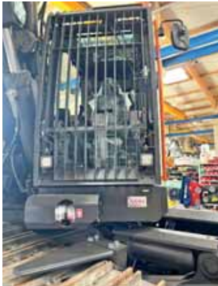
Starker Schutz für den Baggerfahrer. Foto: br
