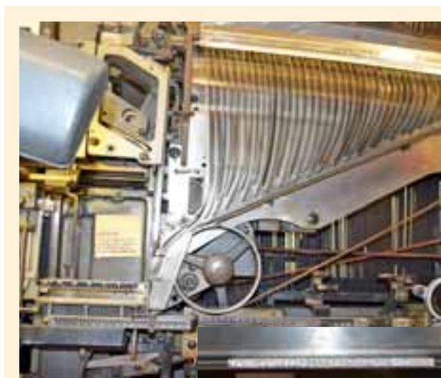
Die einzelnen Drucktypen fallen aus dem Magazin in eine Zeile und werden nach Verwendung wieder automatisch einsortiert.
